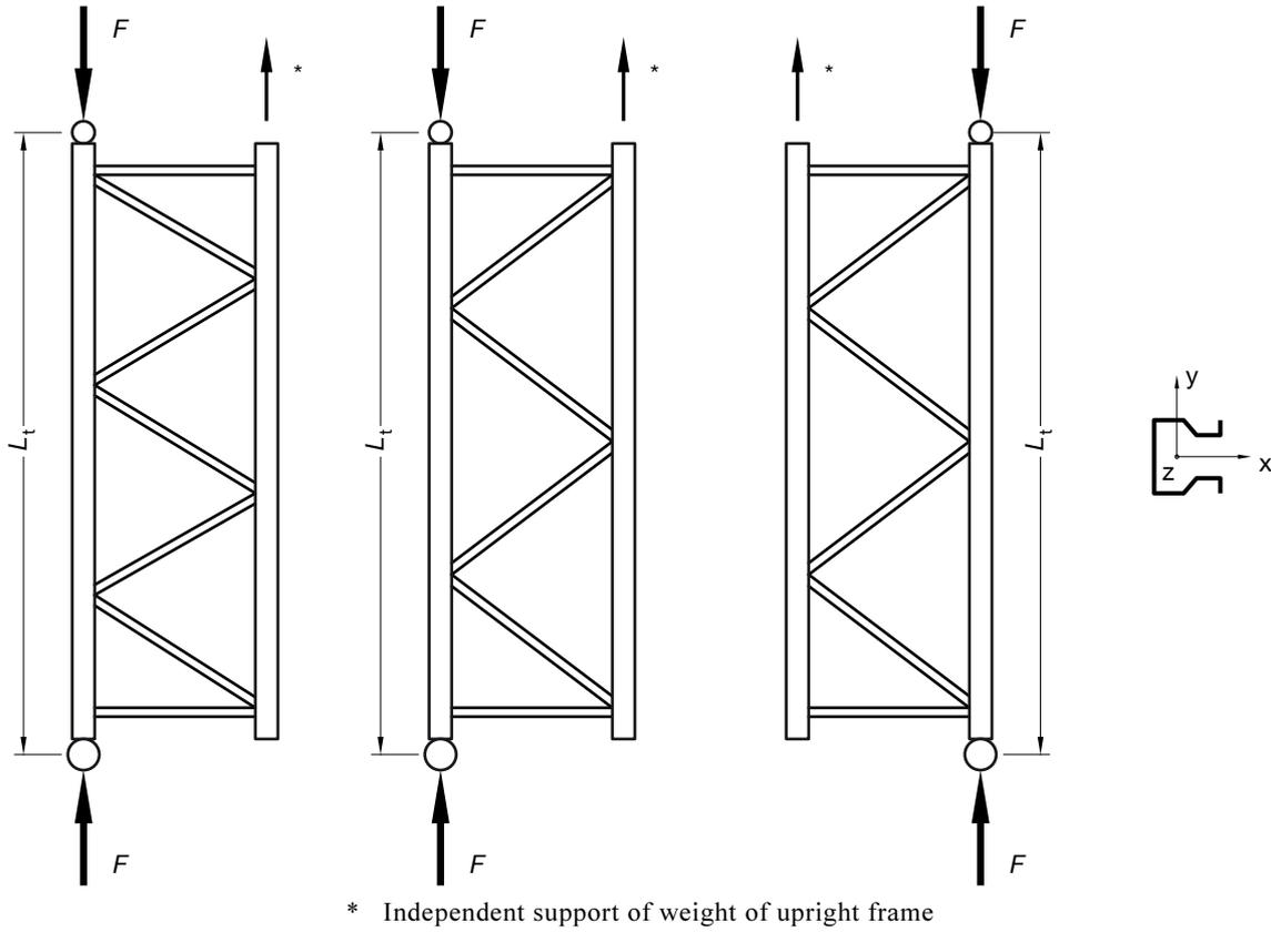
FIGURE 7.3.2.2(a) COMPRESSIVE TEST ON UPRIGHTS
