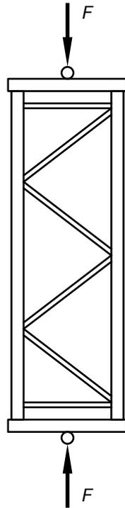
FIGURE 7.3.2.2(b) ALTERNATIVE COMPRESSIVE TEST ON UPRIGHTS
