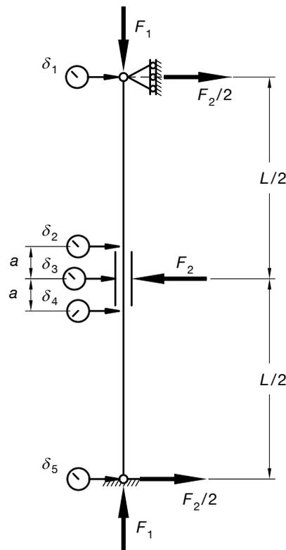
FIGURE 7.8.2 TEST ARRANGEMENT
