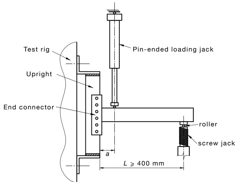
FIGURE 7.5.4.2 ARRANGEMENT FOR THE BEAM END CONNECTOR SHEAR TEST
