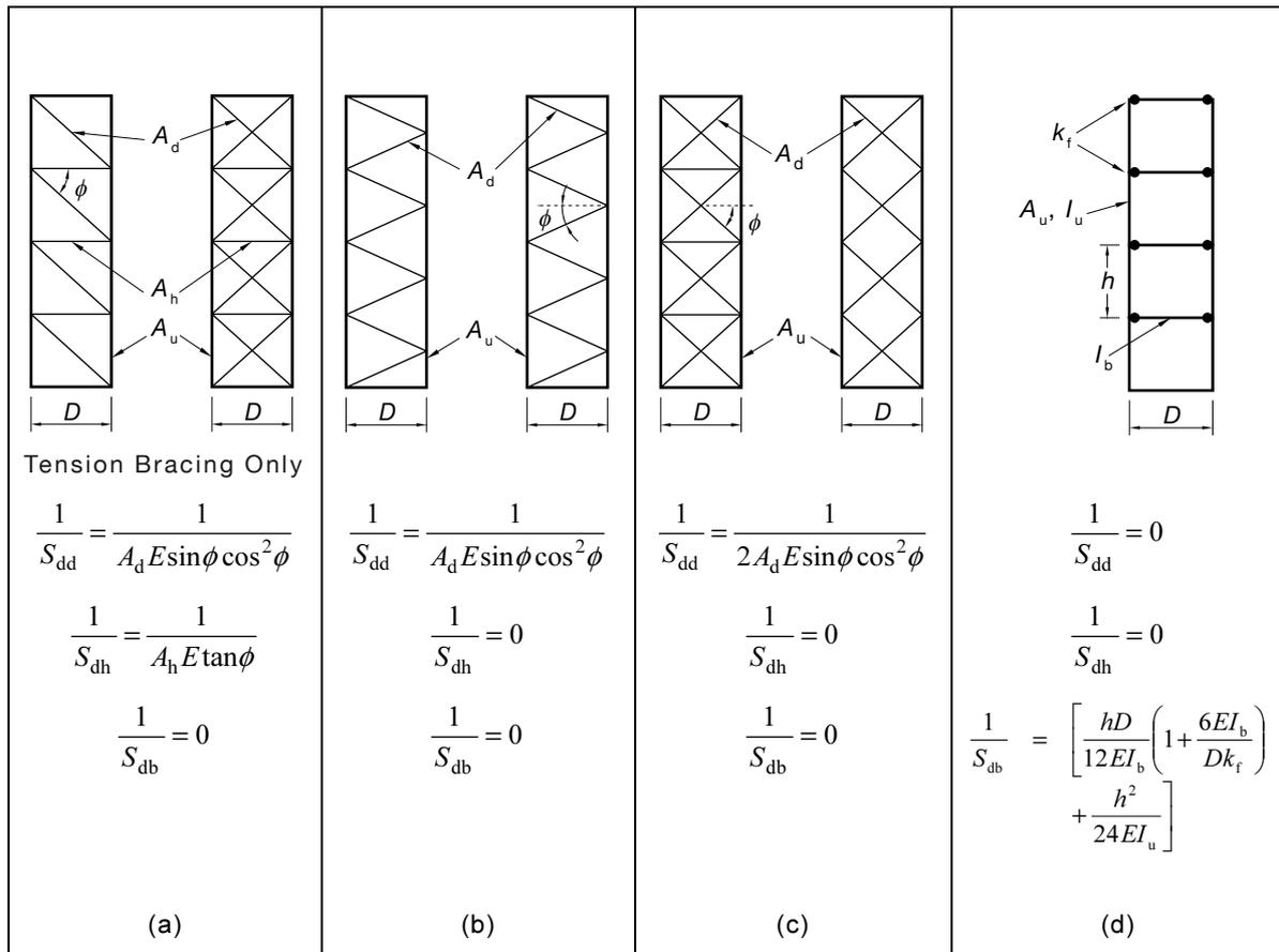
FIGURE C3 SHEAR STIFFNESS FOR UPRIGHT FRAMES
