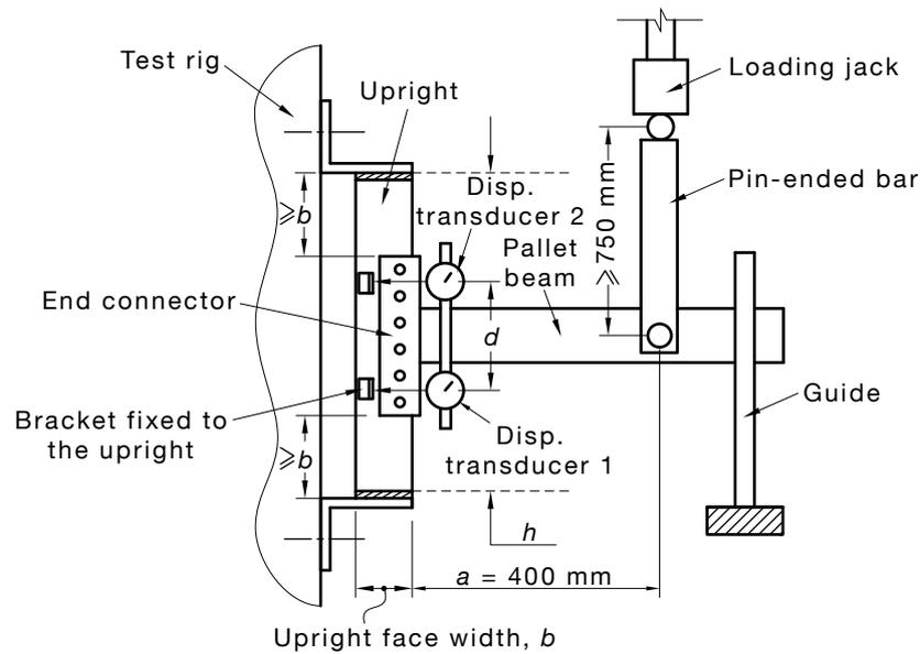
FIGURE 7.5.1.2 SET-UP FOR BEAM END CONNECTOR CANTILEVER TEST
