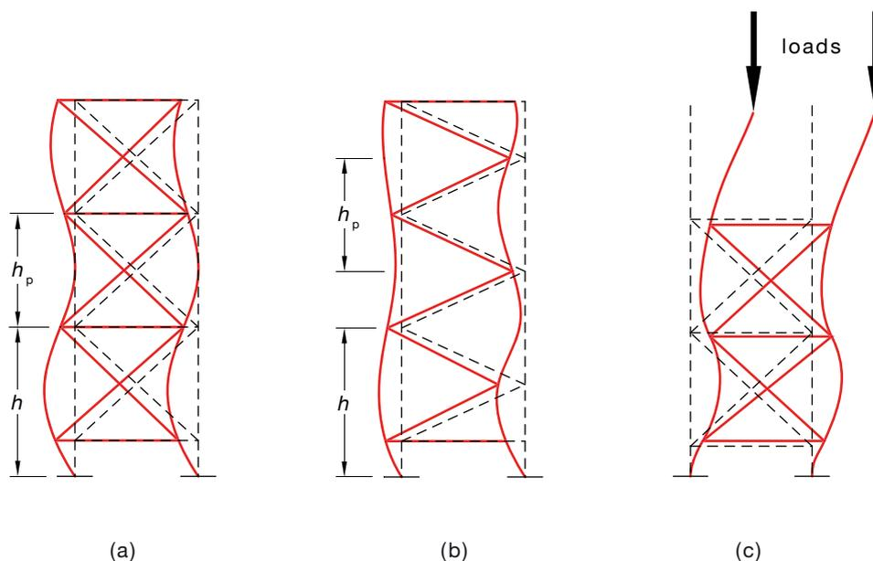
FIGURE 4.2.2.4 IN-PLANE BUCKLING MODES FOR BRACED UPRIGHT FRAMES
