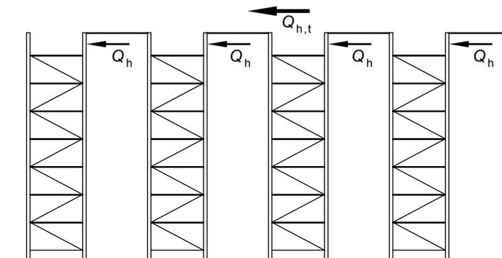
**FIGURE 2.3.5 HORIZONTAL FORCES FROM RACK-GUIDED EQUIPMENT**
