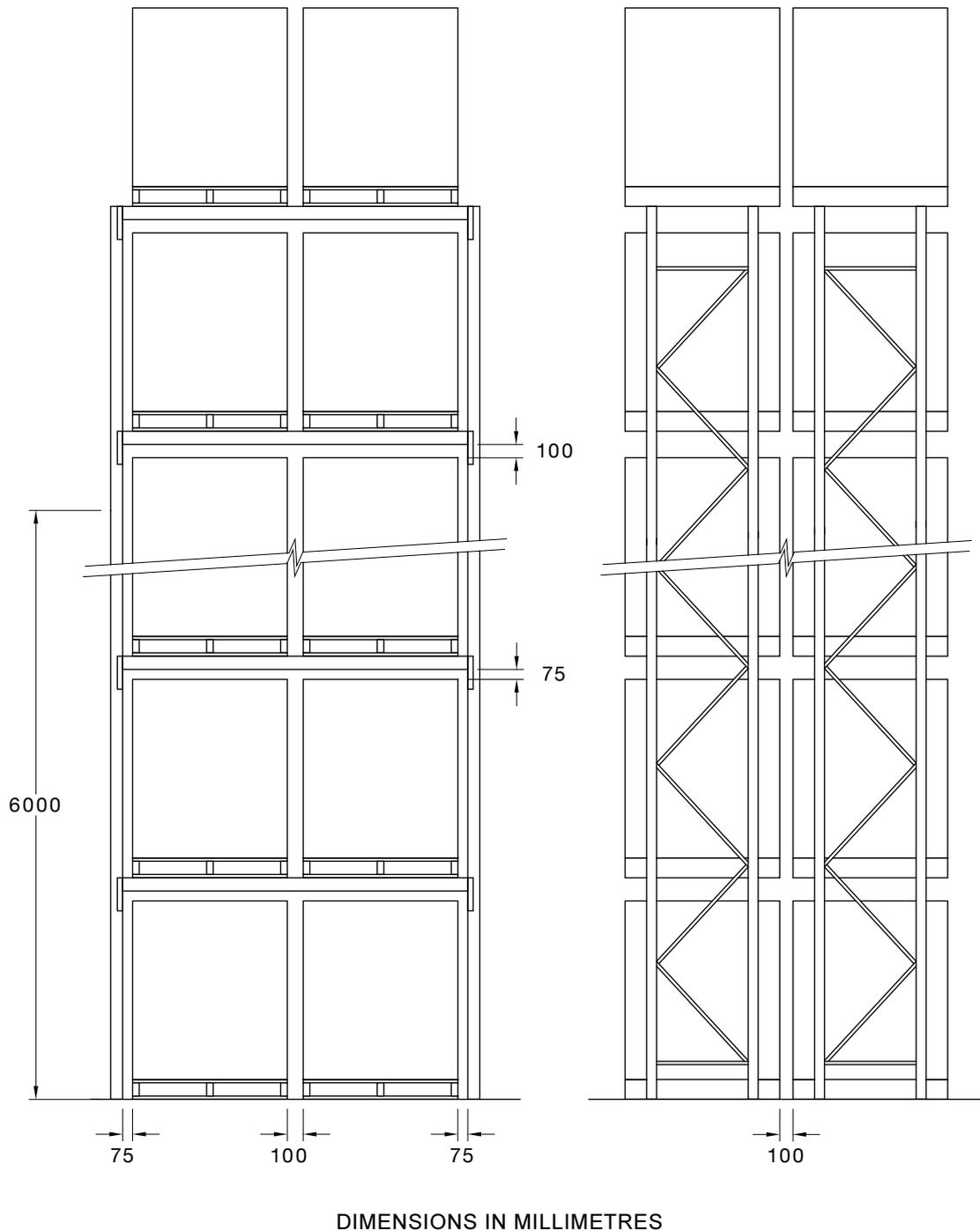
FIGURE 1.7.2 UNIT LOAD OPERATING CLEARANCES
