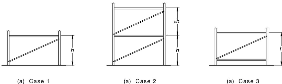
FIGURE 4.2.2.2 FRAMES BRACED IN THE DOWN-AISLE DIRECTION
