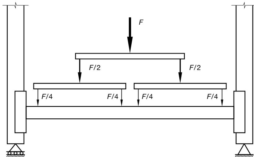
FIGURE 7.4.2.2 ARRANGEMENT FOR BENDING TEST ON A BEAM
