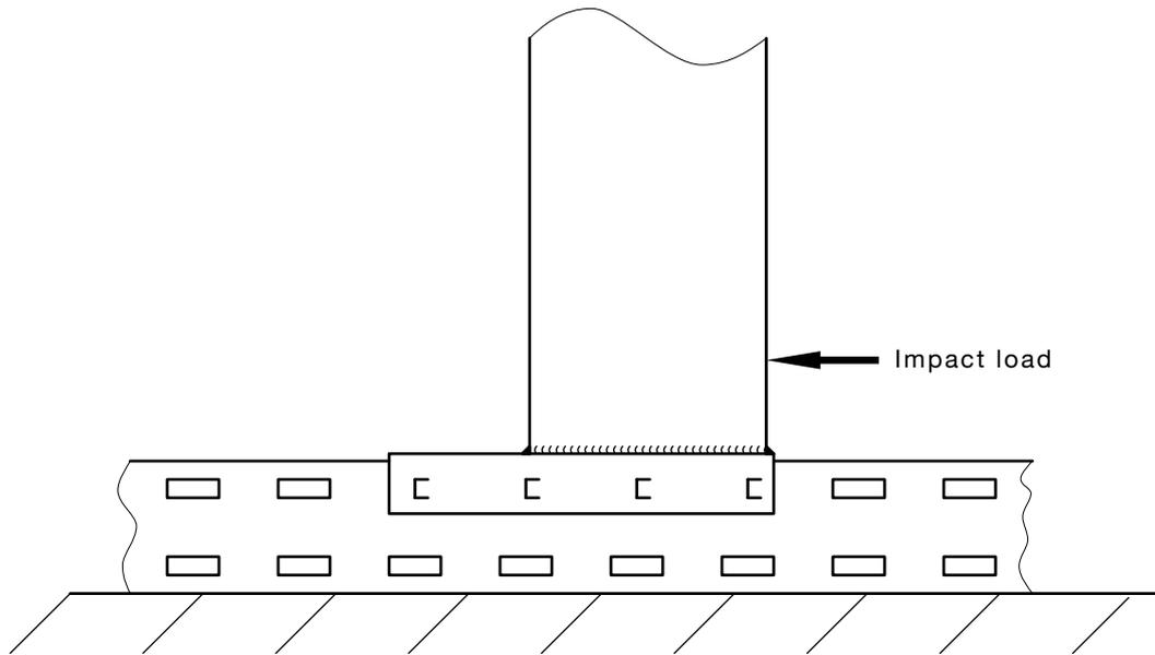
FIGURE 7.10.2(a) TEST ARRANGEMENT OF BEAM TO UPRIGHT CONNECTION
